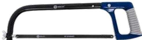
Алюминиевая двухкомпонентная рукоятка, металлическая рамка с упором. Изменяемая длина рамки для полотен 250 и 300 мм. Пильное полотно из высокоуглеродистой стали.
