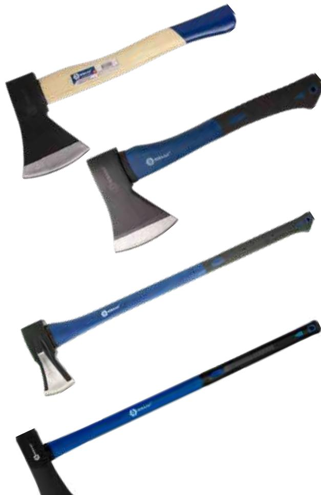
**Топоры-колуны** или валочные топоры обладают удлиненной рукояткой и применяются для валки деревьев и колки дров.
