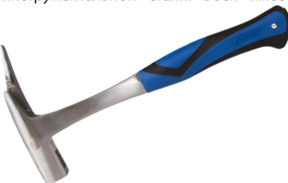
**Молоток каменщика** или молоток-кирочка применяется при работе с кирпичом, камнем, бетоном. Ударная голова выполнена из закаленной инструментальной стали. Боек имеет квадратную форму. Носок имеет сужающийся клин удлиненной формы и используется для разрубания кирпича или камня.
