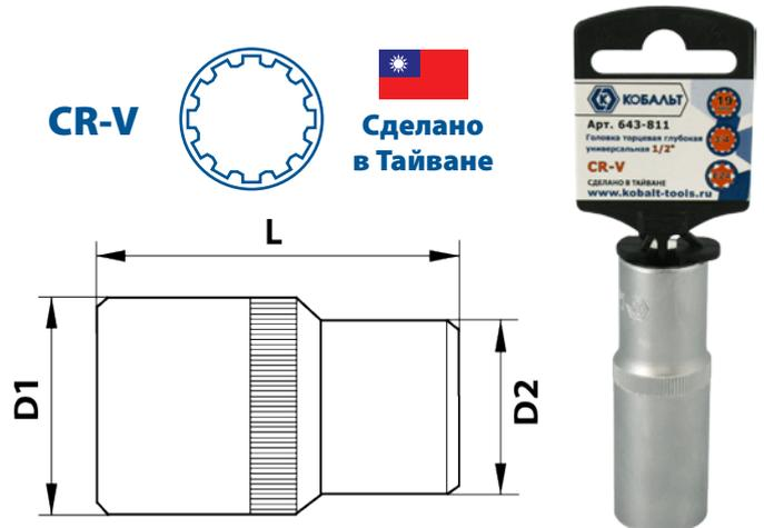
Обладают двенадцатигранным профилем Spline, размером присоединительного квадрата 1/2 дюйма (12,7 мм). Применяются при работе с крепежом имеющим различные профили, а также с крепежом имеющим грани деформированные до 50%. Имеют удлиненную (глубокую) форму.
